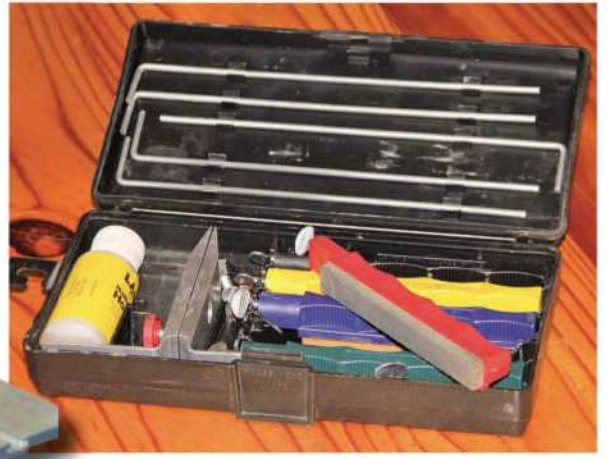
Bandskuurders (links) en die bekende Lansky-slypstelle (bo) is gewilde produkte waarmee mense messe slyp. Wees net versigtig wanneer jy 'n bandskuurder gebruik, want as jy dit verkeerd gebruik kan dit baie van die lem se staal wegslyp. Vir sommige tipes slypwerk neem die Lansky-tipe slypers weer te lank.
