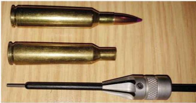
FOTO 3: 'n Goeie ontbraming-dopbeksnyer vir bootstertkoeëls, soos die VLD-ontbramer, kan bydra tot 'n seepgladde inskuif van die koeël in die doppie in, sonder om die stertgedeelte te beskadig.
