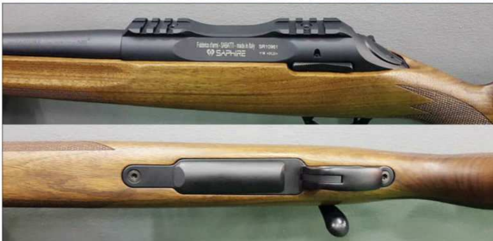
Die boonste foto toon die integrale Picatinny rail in die aksie vir teleskoopbasisse en die onderste een die onderkant van die Saphire se magasyn. Die magasynkapasiteit is drie.
