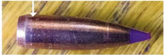
FOTO 4: Skade aan die koeël se bootstert en basisoppervlak word veroorsaak deur doppe wat nie reg ontbraam is nie. Dit lei ook tot waggelpatrone.
