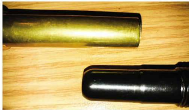
FOTO 1: Die strekpen met die oopsper-rif in die matrysstel word vir parallelwanddoppe verskaf en word gebruik om die doppie se bek effens te sper sodat 'n platbasiskoeël glad gepas kan word.
