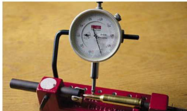
FOTO 5: Hier is 'n voorbeeld van 'n waggelmeter. Dis feitlik onmoontlik om te verwag dat alle patrone 'n zero-afwyking op die waggelmeter het.
